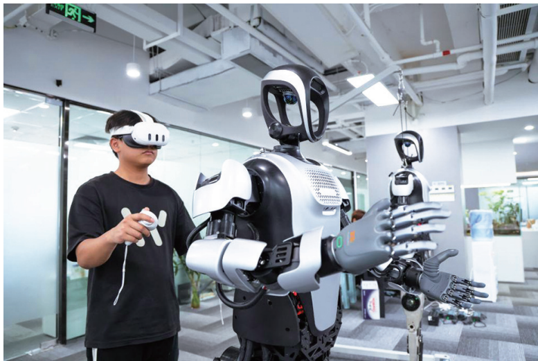
2025年3月27日，在位於廣東省深圳市的樂聚（深圳）機器人技術有限公司，技術人員在調試人形機器人“誇父”。新華社記者 梁旭攝
